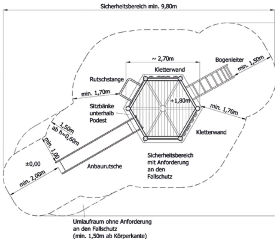
Auch diese Türme mit Stahlpfosten sind durch Anbauelemente aus unserem **modulodus**-Baukasten beliebig erweiterbar.
